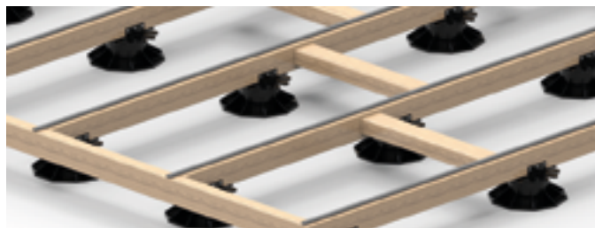
Bei Holzunterkonstruktionen müssen die Verstellfüße immer angeschraubt werden und eine Rahmenkonstruktion sorgt für die notwendige Stabilität.
