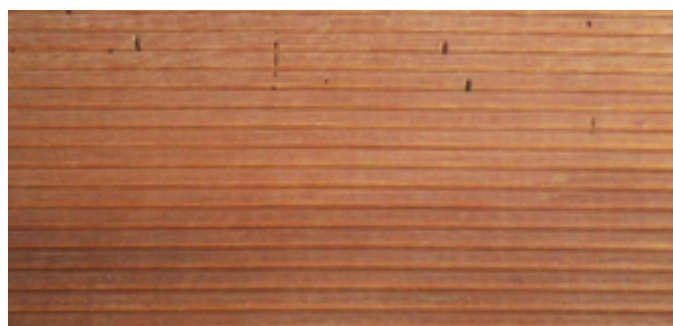
Kleine Löcher durch Insektenfrassgänge sind bei einigen Tropenhölzern normal und nicht vermeidbar.
