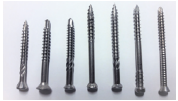
Unterschiedliche Schraubenköpfe und Bohrspitzen beeinflussen das Schraubbild.
