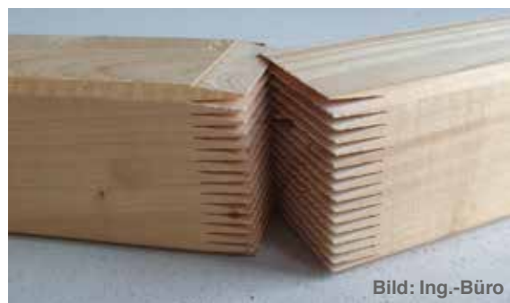
Abb. 11 Keilzinkenverbindung zum Fügen eines Endlosstranges
