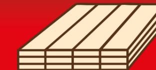
nach EN 13353 • formaldehydfreie Verleimung D3 nach EN 204 • 5 mm Decklage • Mittellage gleich Decklagenholz • beidseitiger Oberflächenschliff mit Korn 80
