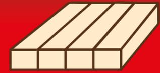
nach EN 13353 • formaldehydfreie Verleimung D3 nach EN 204 • Lamellenbreite ca. 40 – 70 mm • beidseitig geschliffen mit Korn 80
