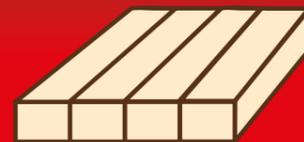
nach EN 13353 • formaldehydfreie Verleimung D3 nach EN 204 • Lamellenbreite ca. 40 – 70 mm • beidseitig geschliffen mit Korn 80
