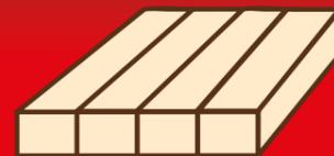
nach EN 13353 • SWP/2 Verleimung • Lamellenbreite 40 – 43 mm • dickenkalibriert und feingeschliffen Korn 60
