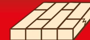
nach EN 13353 • formaldehydfreie Verleimung D3 nach EN 204 • Lamellenbreite ca. 40/42 mm • beidseitig geschliffen mit Korn 80
