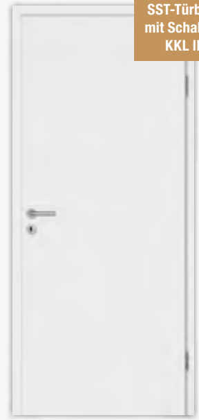
Schallschutz-Türblatt (SST) Schallschutz (SD32 = Rw, P 32 dB) Klimaklasse III inkl. Schall-Ex, Bänder V0026, PZ vorgerichtet
