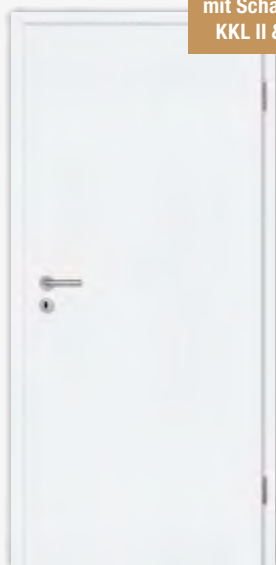
Schallschutz-Türblatt (SST) Schallschutz Klasse 1 (SD32 = Rw, P 32 dB) und Schallschutzklasse 3 (HSD43 = Rw,P 43dB) inkl. Schall-Ex, Bänder V0026WF, PZ vorgefertigt.
