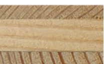
3-SCHICHT NADELHOLZPLATTE MIT NADELHOLZ-MITTELLAGE
