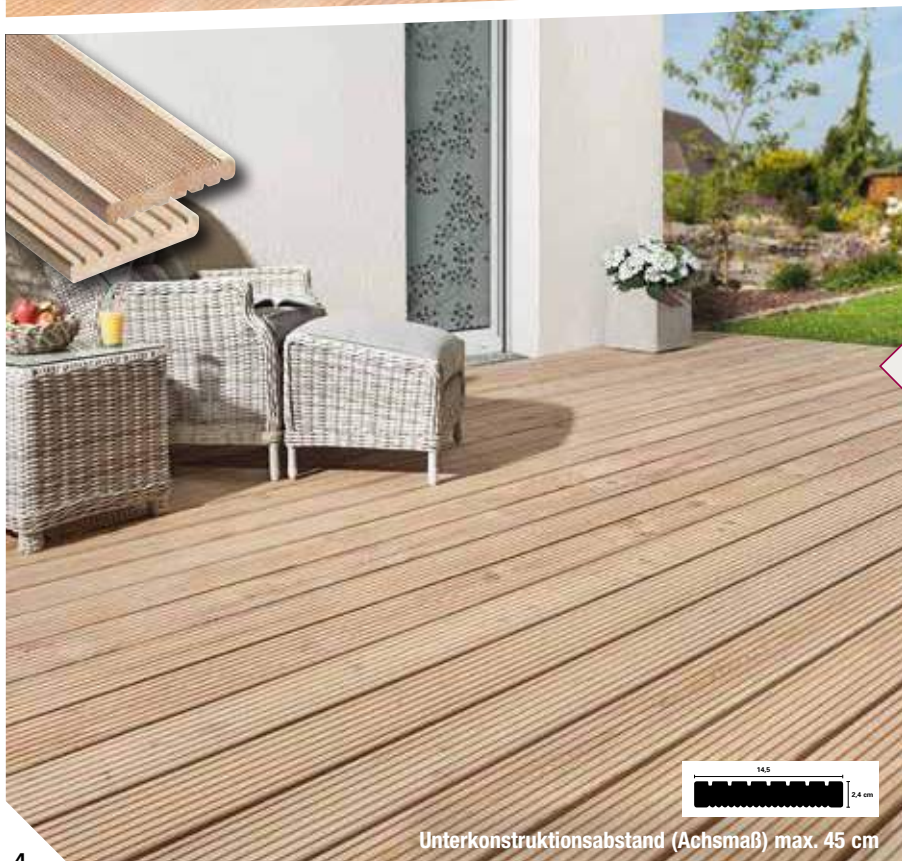
Unterkonstruktionsabstand (Achismaß) max. 45 cm
