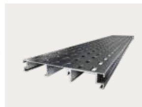
Drainageprofil Schutz vor Spritz- und Regenwasser, Unterlüftung des Terrassendecks, Längen: 1900 und 3000 mm
