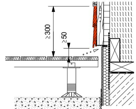
Abb. 3: Versleißbretter müssen aufgrund der kürzeren Lebensdauer leicht austauschbar sein.
