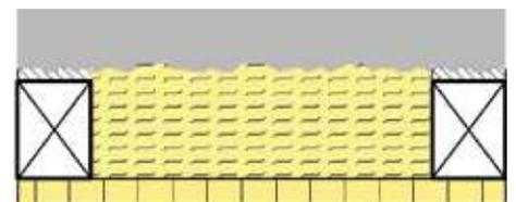
Abb. 3b: Abhilfe kann der übermäßige Einbau des Dämmstoffes bringen (+ 2 cm) oder der Einsatz von Einblasdämmstoffen.
