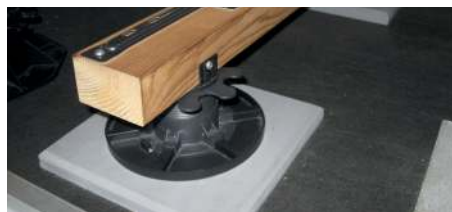
Abb. 9: Mit Stelzlägern lässt sich eine Aufbauhöhe von mindestens 300 mm leicht herstellen. In verstellbarer Ausführung ist ein Höhenausgleich des Untergrundes möglich.
