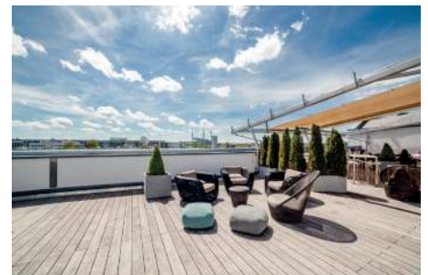
Abb. 16: Für Dachterrassen kommen auch modifizierte Hölzer, z. B. Kebony® (Behandlung mit Furfurylalkohol), zum Einsatz. Bild: Weltholz
